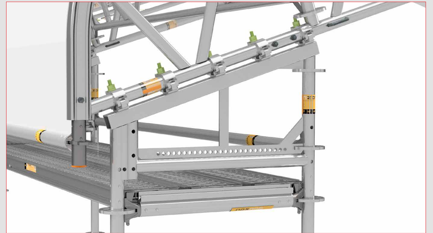
屋根サポートは、幅が中心寸法700 mm、732 mm、750 mmの枠組またはモジュール式足場に取り付けることができます。
